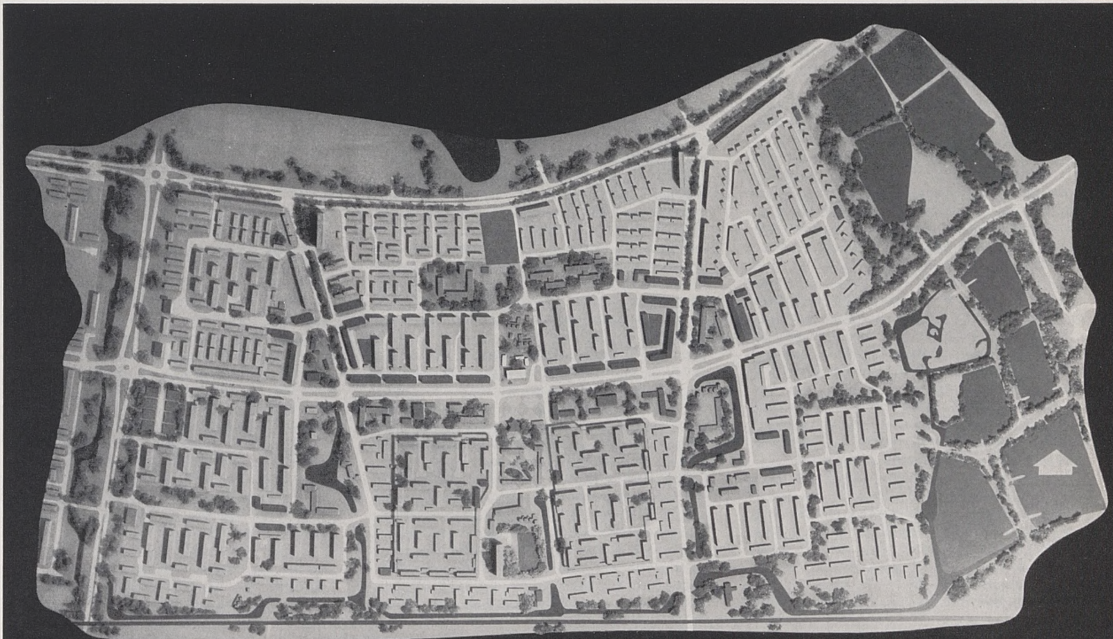
Quartier Zuidwijk, Rotterdam 7000 habitations: 22 % pour une famille, 75 % en étages, 3 % plus de 4 étages Le centre montre le caractère dynamique de « la rue à flâner », accompagné par la circulation du quartier
